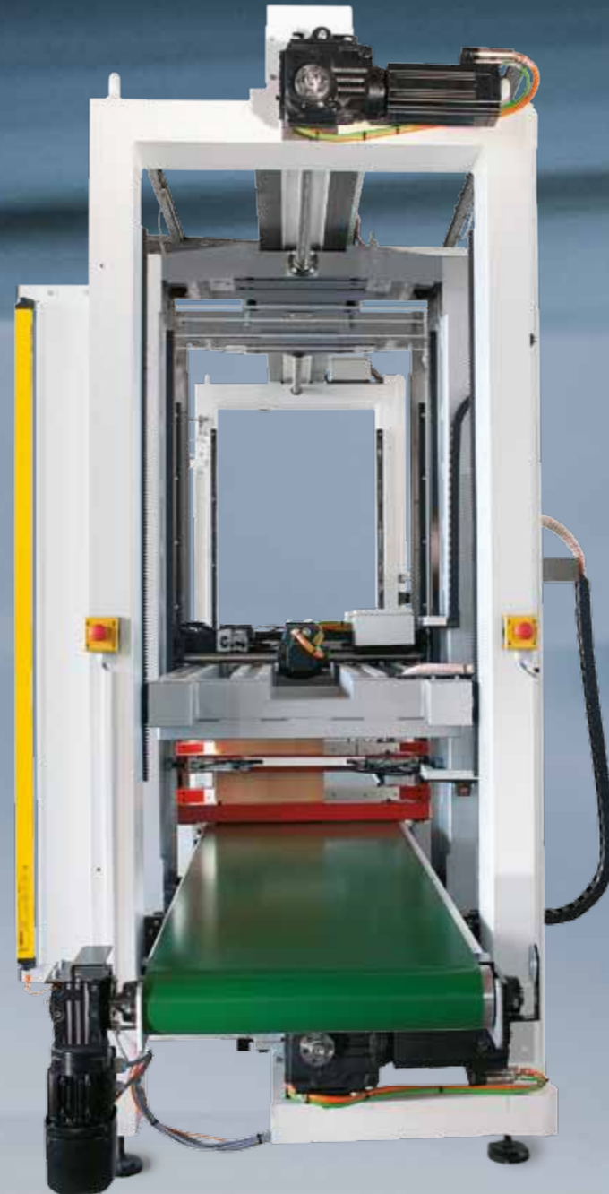
Empfangseinheit für exakte Korpus-Längenvermessung – diagonal über Infrarot und Spiegel.
