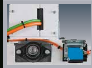
Exakte Korpus-Höhenvermessung über Laser.
