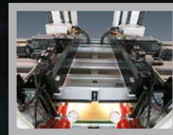
Vertikaler Druck über synchron gesteuerte Servomotoren.
